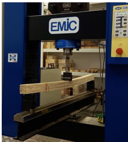
Figura 8 - Ensaio de flexão simples em viga de MLC
