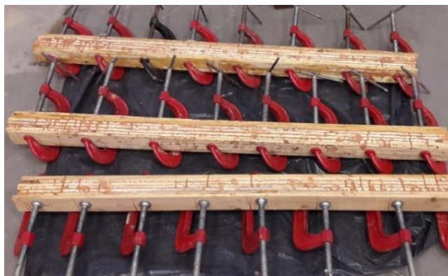
(b) Processo de cura das vigas
