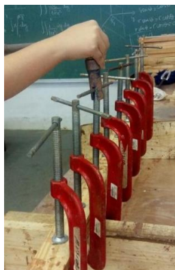
(a) Aplicação de pressão via torquímetro e sargentos
