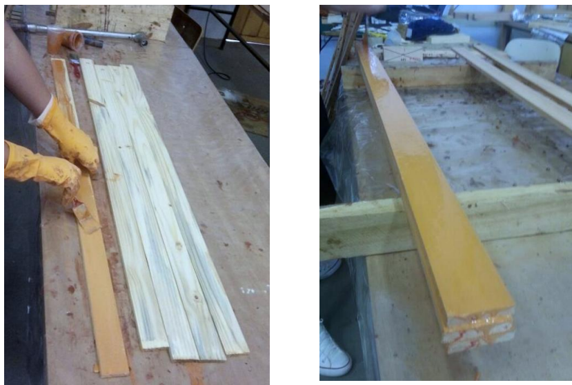
Figura 6 - Aplicação de adesivo com utilização de pincel
