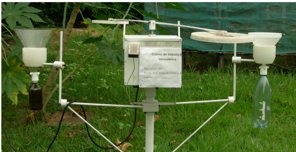
Figura 5. Foto do amostrador automático de deposição atmosférica, alocado no campus da UNESP/São José do Rio Preto, ilustrando a abertura dos coletores.
