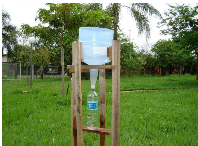
Figura 4. Foto do amostrador de deposição atmosférica total, alocado no campus da UNESP/São José do Rio Preto.
