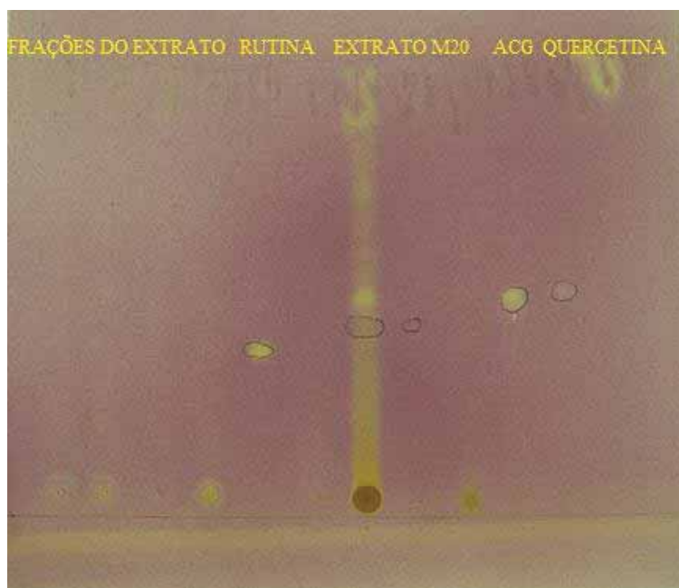
Figura 2.10 Autobiografia da cromatoplaça de extrato M20 EtOH 70 e suas frações, rutina, quercetina e ácido clorogênico (ACG) revelados com solução de DPPH•
