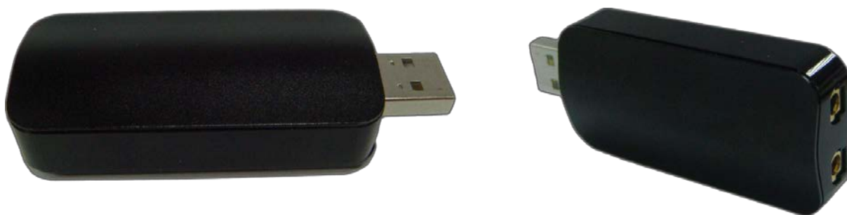
Figura 19: Modulador de RF USB com suporte para transmissão e recepção ISDB-t
