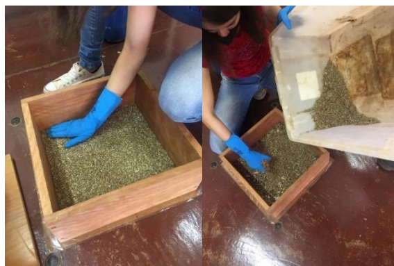
Figura 21 – (a) acomodação da camada externa do painel e (b) deposição das partículas para formação do núcleo do painel
