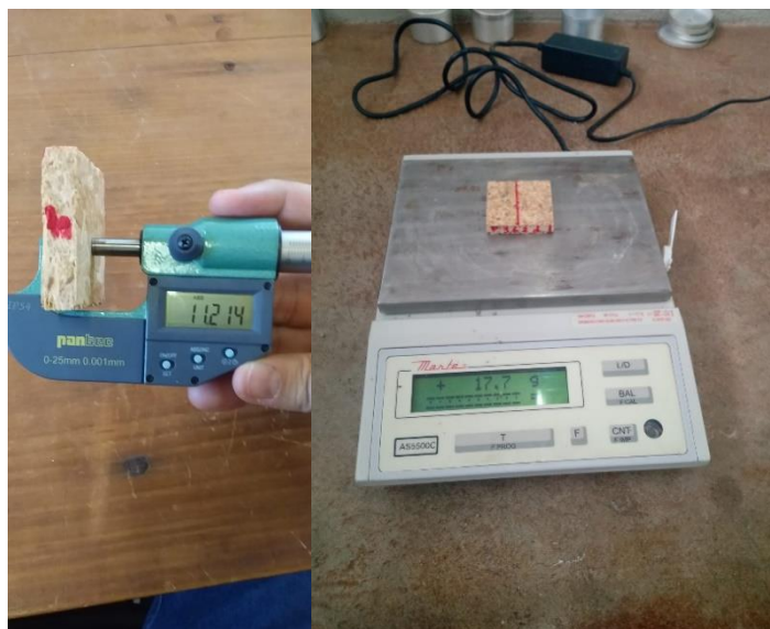
Figura 24 – (a) Aferição da E_0 e (b) da M_0
