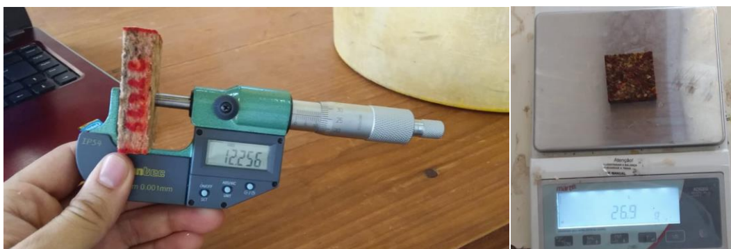
Figura 25 – (a) Aferição da espessura utilizando um micrômetro digital para avaliação do inchamento e (b) pesagem do cp úmido para avaliação da absorção
