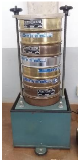
Figura 17 - Aparato para determinação da granulometria da amostra
