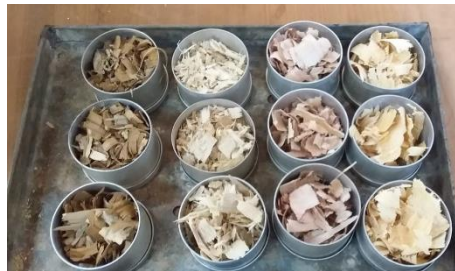
Figura 19 - Preparação das amostras para o ensaio de teor de umidade
