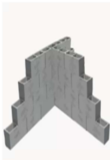
Figura 8 – Parede em alvenaria estrutural. (a) desenho esquemático. (b) foto de obra.
