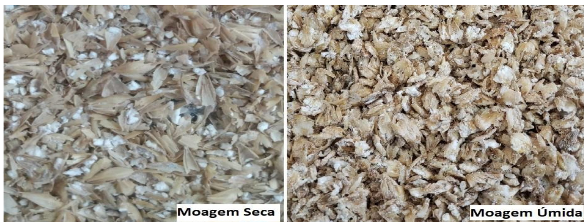
Figura 8 – Moagem seca e Moagem úmida para moinhos de rolos.
