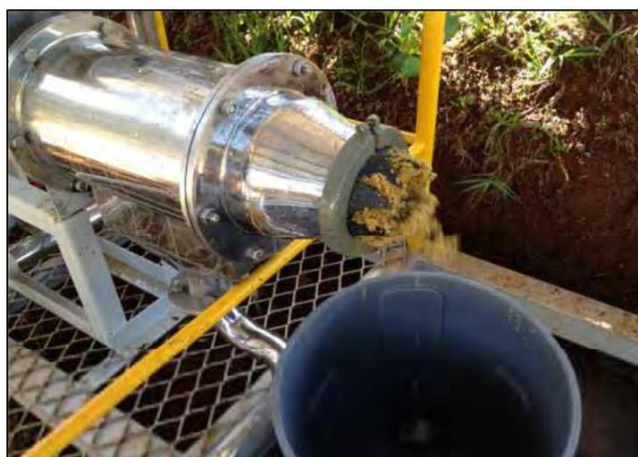
Apêndice 3. Peneira rotativa (separador de partículas de CF diluída), fabricada de aço inox 306, com malha circular de 0,5 mm e motor de 2 cv.
