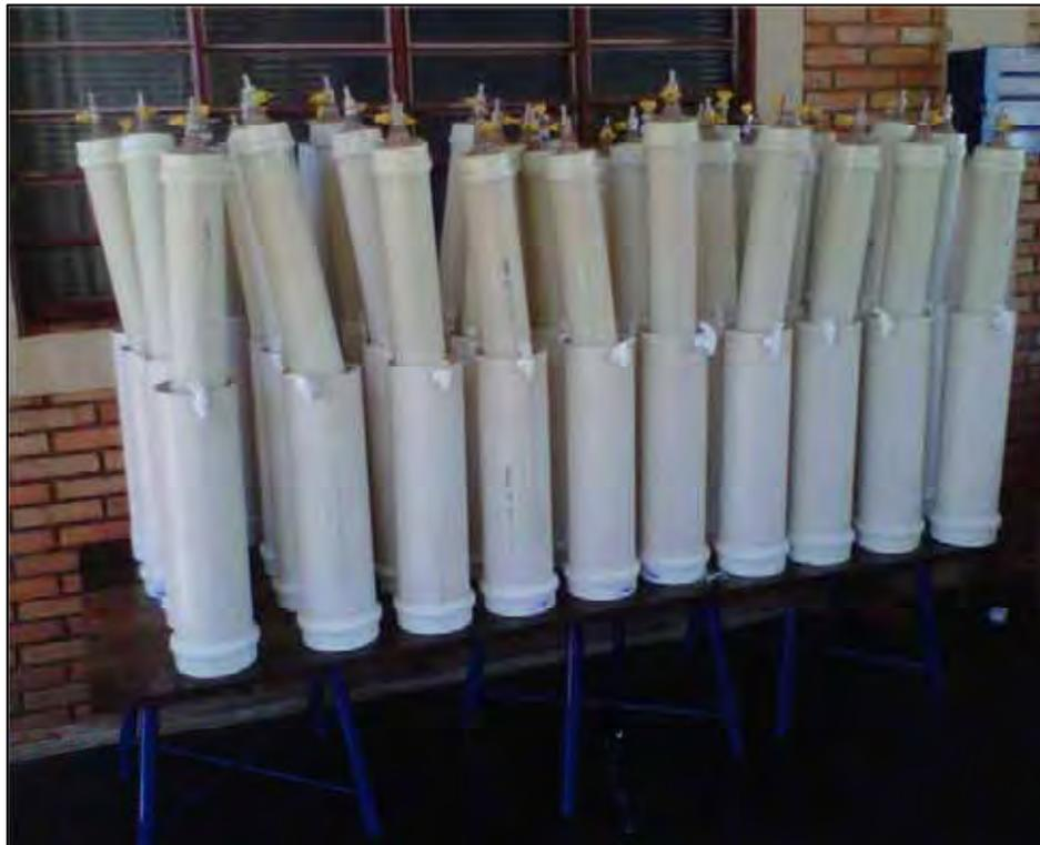
Apêndice 12B. Biodigestores bateladas, utilizado no ensaio experimental de BA.
