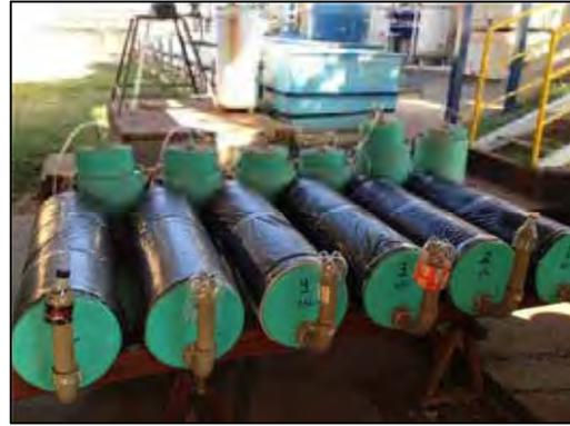
Apêndices 16A e 16B. Biodigestores contínuos, confeccionados para o ensaio de BA.
