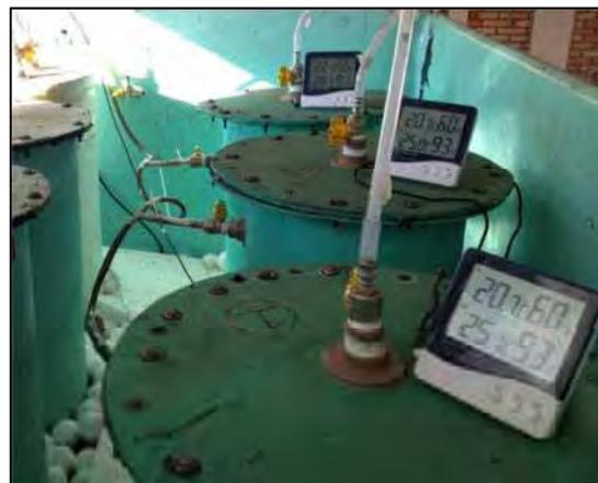
Apêndices 17A, 17B e 17C. Protótipo de compostagem "in-vessel". T1: Tanque de aquecimento dos reatores, volume 3 m<sup>3</sup>, de 1200 x 2500 mm. E1: Estrutura metálica de suporte, que eleva para 1700 mm a cima do piso, na parte inferior o tanque possui um dreno para facilitar a retirada de água e efluente dos reatores. T2: Tanque de aquecimento de água de reciclo do T1, com capacidade de 0,25 m<sup>3</sup>. B1: Bomba de água quente utilizada para envio de água quente do T2 para o T1.
