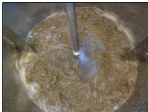
Apêndice 1. Tanque de diluição e desaglomeração de partículas de cama de frango de corte, com capacidade de 500 litros e fabricada em aço inox 306, constituída de motor de 1 cv., impelidores e defletores.
