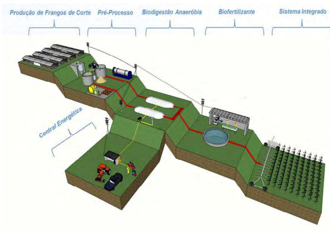
Apêndice 18. Planta em 3D do sistema modelo para aproveitamento energético de cama de frangos de corte.
