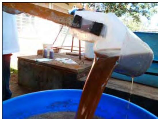
Apêndices 11A e 11B. Fração sólida e fração líquida de cama de frangos de corte, após separação de frações sólida e líquida por peneira estática e rotativa.
