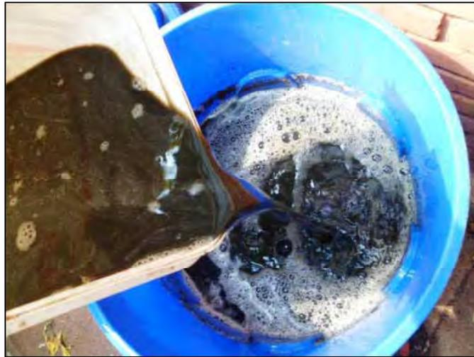
Apêndice 13. Inóculo utilizado nos ensaios experimentais, coletado de biodigestores contínuos de dejetos de bovinos e de CF biodigerida em sistema híbrido, com mistura de 1:1
