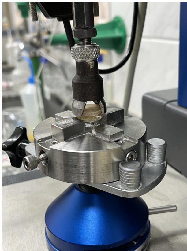
Figura 9 - Corpo de prova de tração posicionado em máquina de ensaios mecânicos (EMIC DL 2000)
