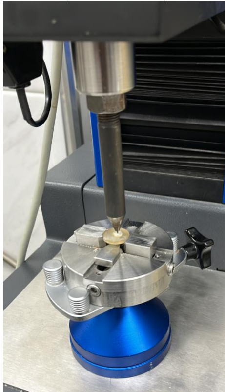
Figura 2. Corpo de prova de push-out posicionado em máquina de ensaios mecânicos (EMIC DL 2000)
