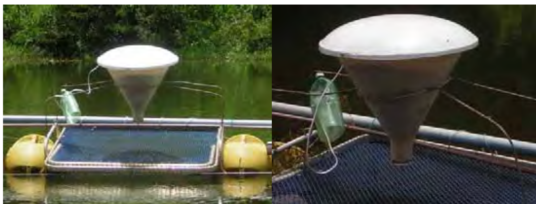
Figura 02 – Detalhe do suporte metálico e do dispensador automático de ração Figure 02 - Detail of the metal support and of the automatic feeding
