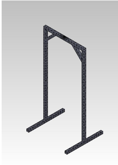
Figura 25 – Aplicação da malha de elementos finitos.
