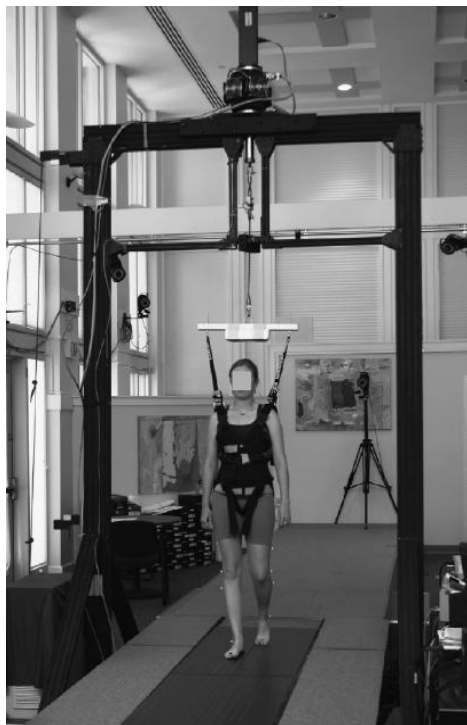
Figura 5 – Sistema de suporte peso corporal
