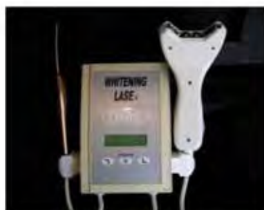
FIGURA 3a – Laser de diodo contendo como meio ativo InGaAlP
