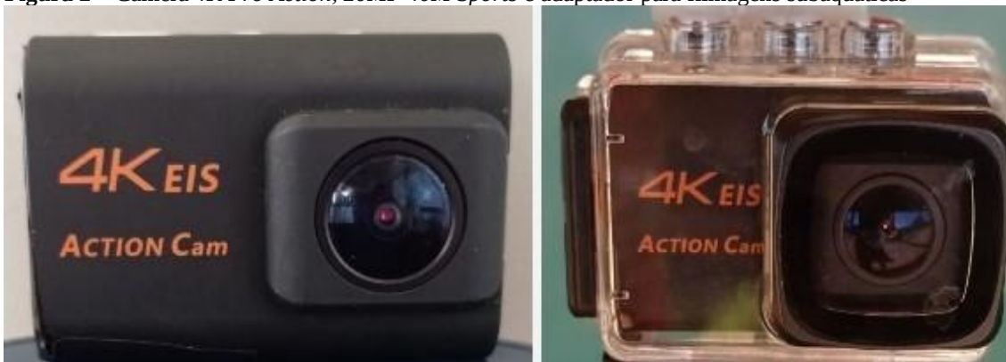
Figura 2 – Câmera 4K Pro Action, 20MP 40M Sports e adaptador para filmagens subaquáticas
