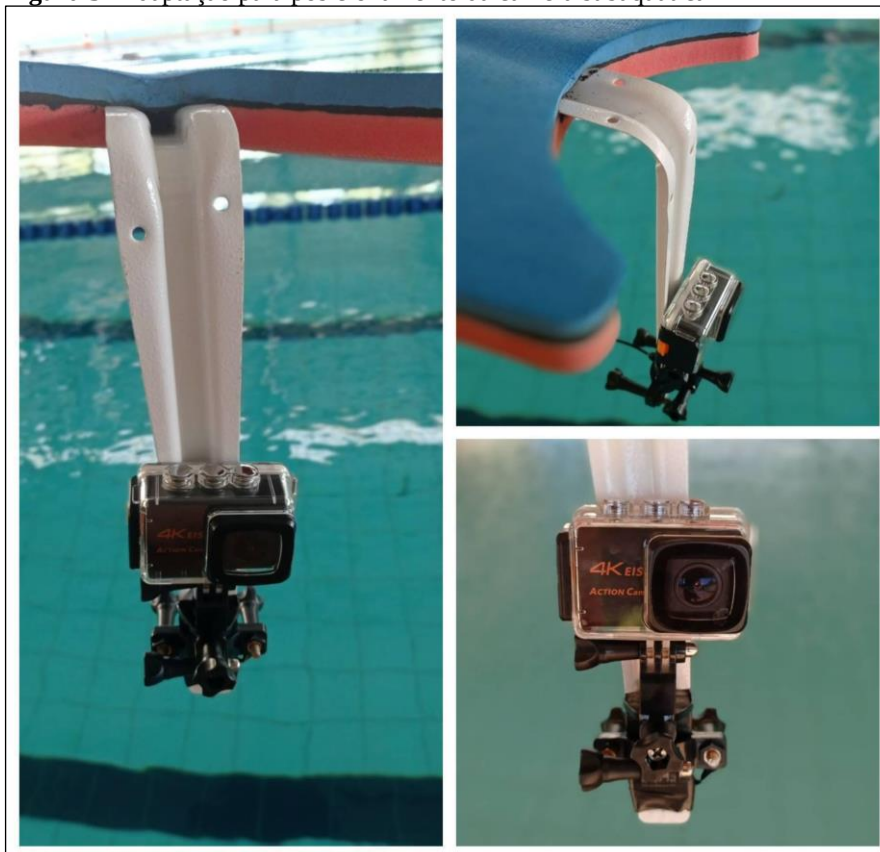
Figura 3- Adaptação para posicionamento da câmera subaquática
