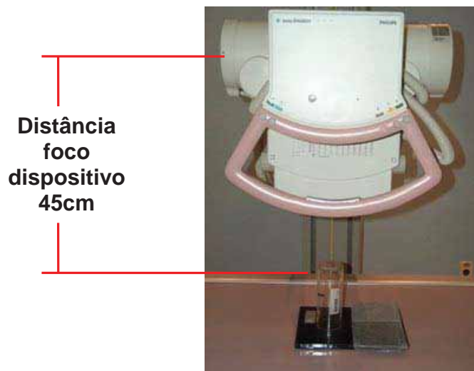
Figura 27: Montagem do teste de verificação do ponto focal.
