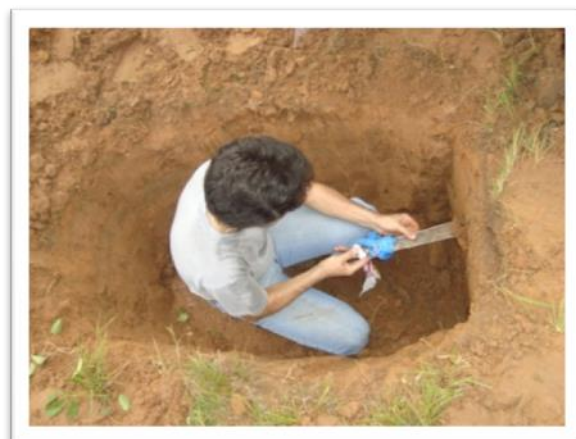
Figura 59. Retirada das amostras de solo tecnogênico para realização de análise física (textura e fracionamento). Fonte: Autores (abril de 2012)
