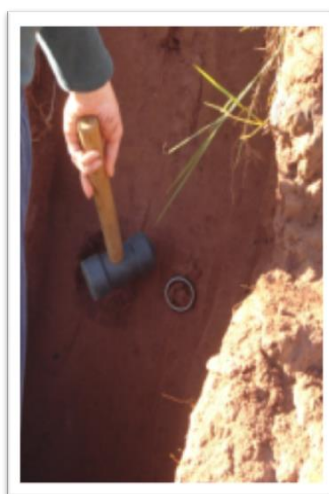
Figura 22. Fixação do anel volumétrico para determinação da densidade do solo. Autores (junho de 2011)
