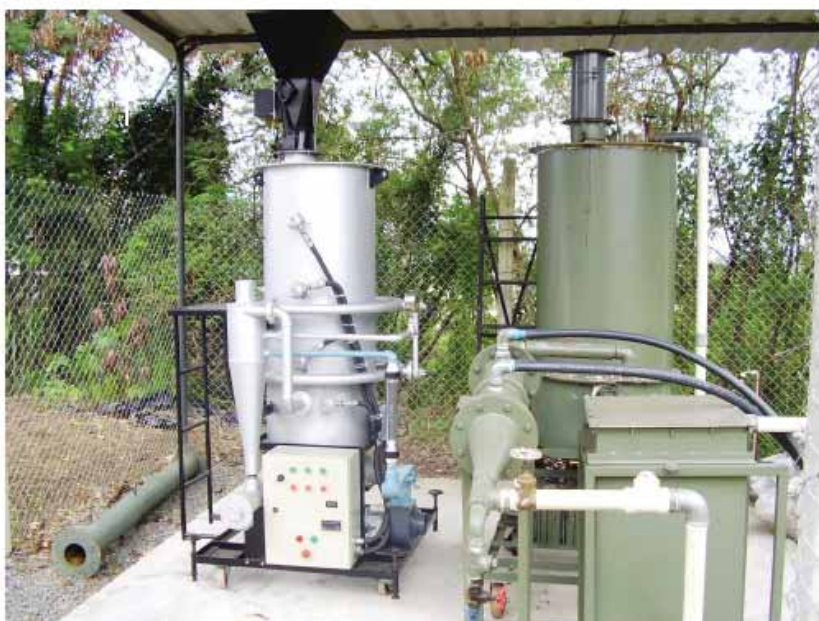
Figura 16: Primeiro e segundo protótipo de gaseificadores downdraft construídos no Departamento de Energia da faculdade de Engenharia de Guaratinguetá (Proj. CTENERG, 2006)
