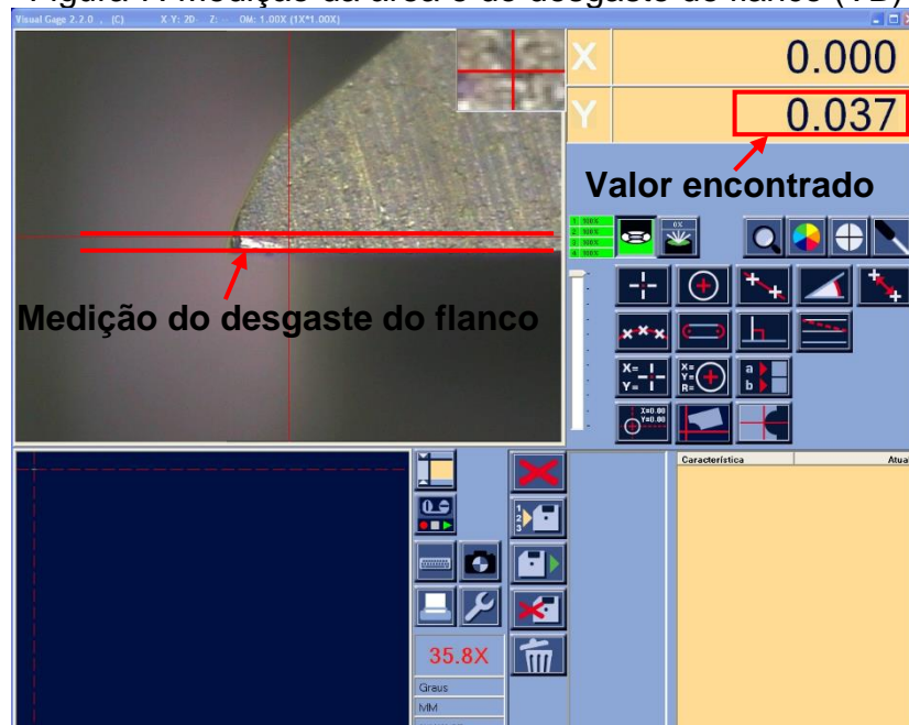
Figura 7: Medição da área e do desgaste de flanco (VB)
