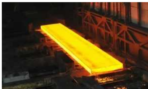
Figura 12 - Ferro aquecido emitindo a cor visível amarela.
