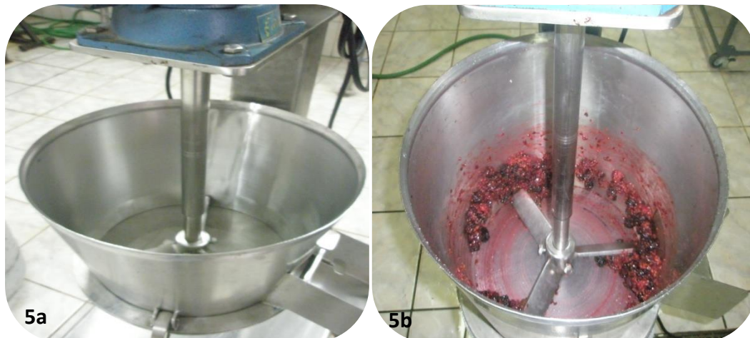
Figuras 5a e 5b: A despulpadeira em aço inoxidável descontinua com peneira de malha 0,5 mm utilizada no experimento e a mesma em funcionamento.
