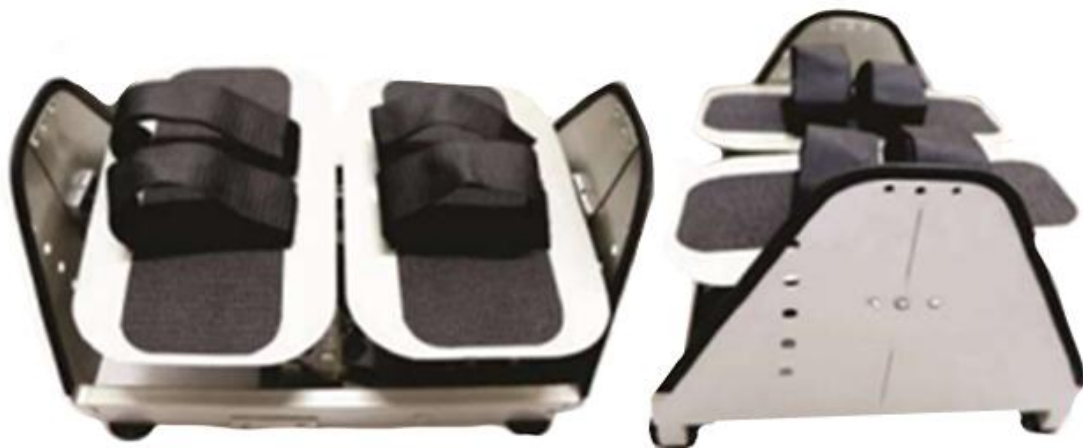
FIGURA 30 - Protótipo de apoio de pés com movimentação passiva eletrônica
