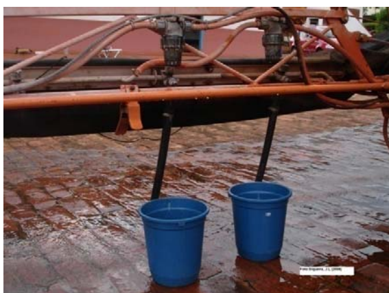
Figura 6. Quantificação do vazamento presente no pulverizador
