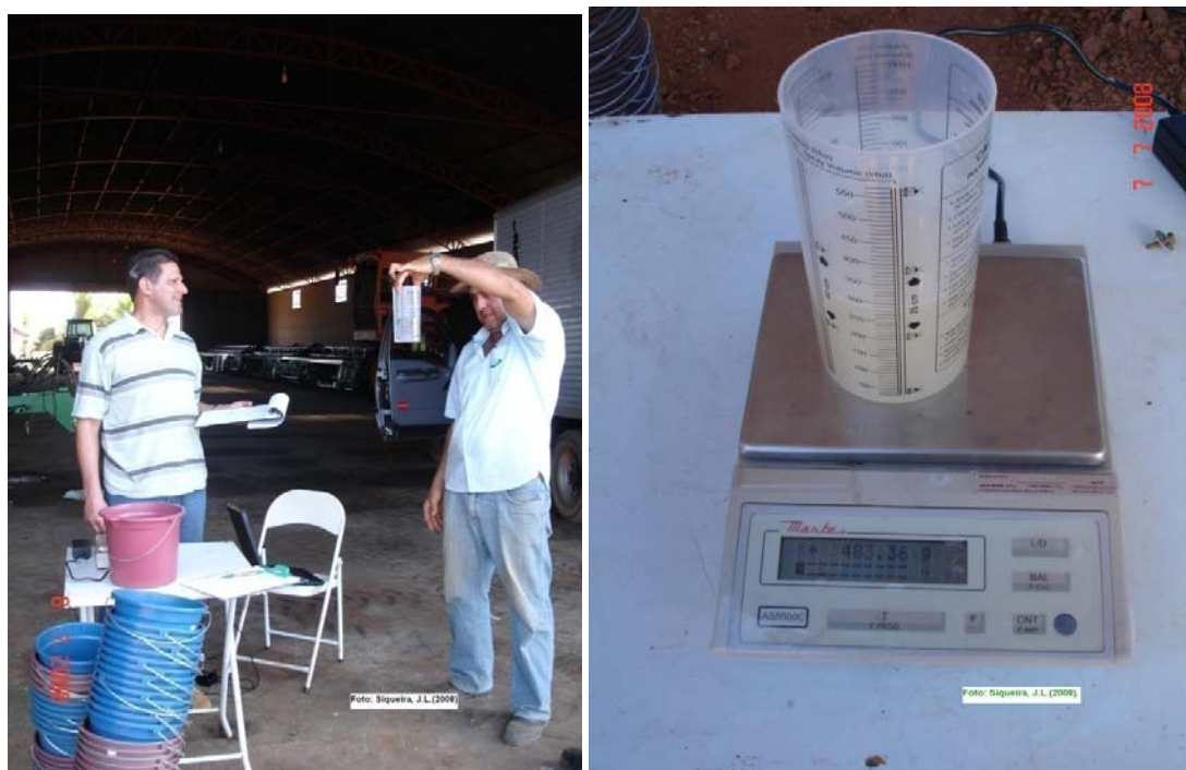
Figura 5. Leitura do volume de água (mL) e posterior pesagem (g)
