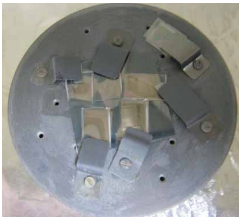
Figura 15 - Foto dos substratos fixados no porta substrato, foram mantidas as mesmas posições nas duas deposições.
