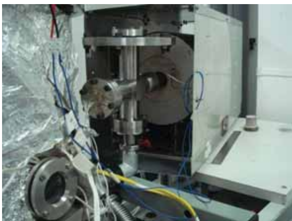
Figura 16 – (a) foto do tubo de quartzo dentro do forno; (b) foto de todo o sistema.
