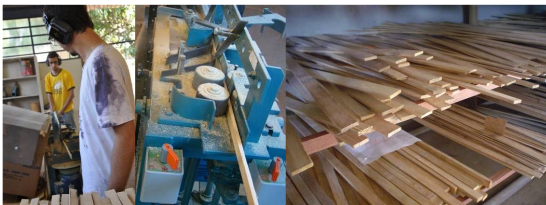
Imagem 2. Mostra o processamento de desgrosso das ripas e a classificação por espessura.
