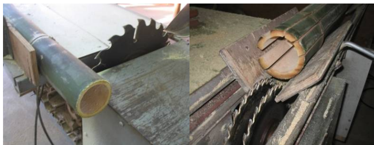
Imagem 1. Mostras o processamento com a destopadeira e a refiladeira.
