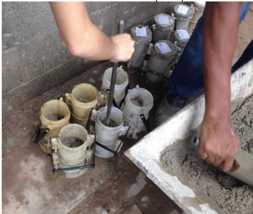
Figura 11 – Adensamento manual de corpo de prova cilíndrico
