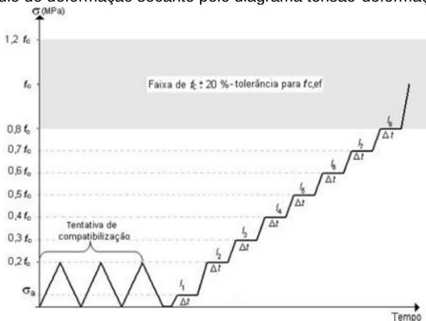
Figura 30 – Representação esquemática do carregamento para a determinação do módulo de deformação secante pelo diagrama tensão-deformação
