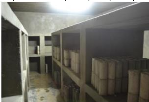
Figura 16 - Câmara úmida com umidade relativa do ar superior a 95 %, à temperatura entre (21 \pm 2)^{\circ}\text{C} e (27 \pm 2)^{\circ}\text{C}
