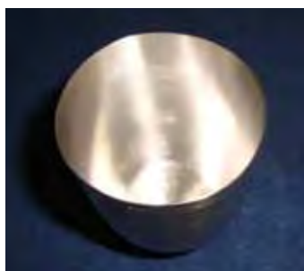
Figura 18: Cadinho de Platina e Ouro utilizado para a fusão do material
