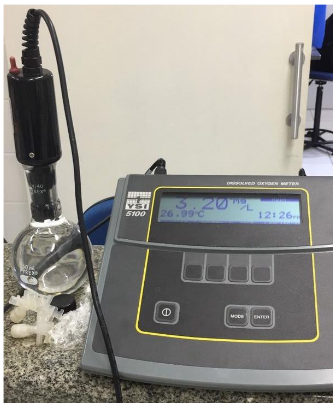
Figura 9. Oxímetro de bancada YSI 5100 utilizado para a determinação das concentrações de oxigênio nas câmaras (Foto: Héllen Siqueira).
