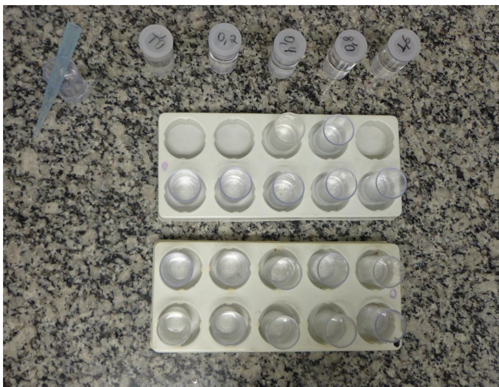
Figura 7 - Padrões 0,1; 0,2; 0,4; 0,8 e 1,6 mgF/L, preparados a partir de solução de NaF e Total ionic strength adjuster (TISAB II; Orion Research, Inc.)
