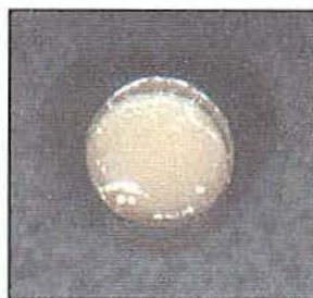
FIGURA 6 – Vista superior da área tratada, após aplicação de adesivo Single Bond , 3M
