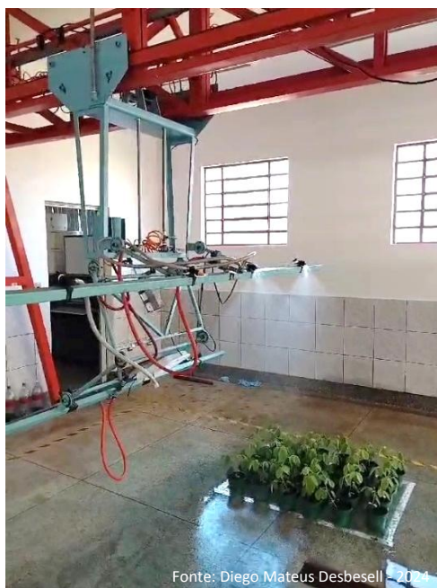
Figura 2 — Simulador de chuva sendo utilizado no momento da execução do experimento. Botucatu. Safra: 2023/24
