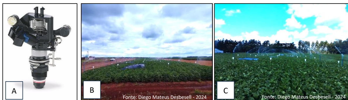
Figura 1 — A- Aspensor modelo Rain Bird Maxi-Pan; B- Esquema de montagem sistema irrigação para simular chuva no Local 1; C- Esquema de montagem sistema irrigação para simular chuva no Local 2. Cambé, PR. Safra: 2022/23
