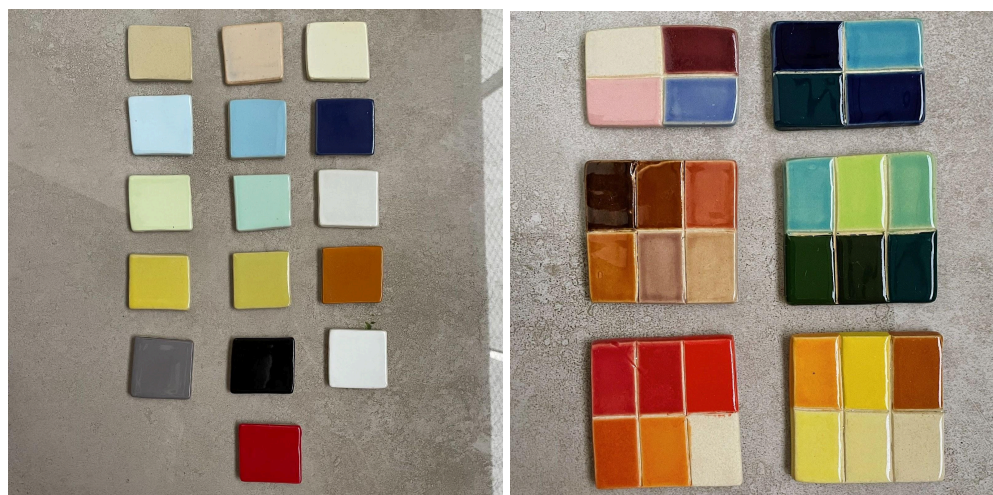
Imagem 4: Composição de fotografias tiradas pela autora dos testes de esmaltes queimados a cone 6 (1220°C) realizados em 2020.
