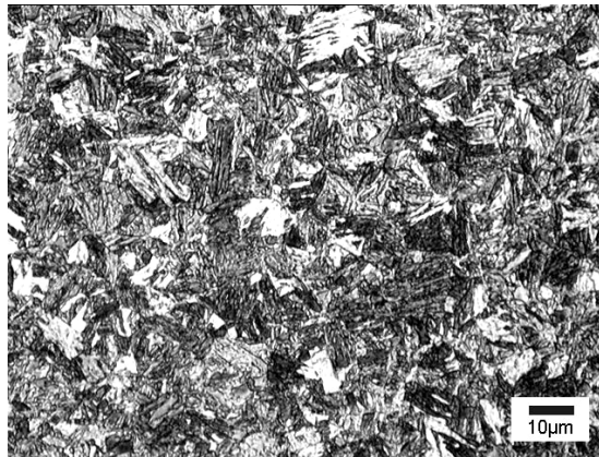
Figura 2.16 - Microscopia óptica de uma microestrutura típica de um aço martensítico. Ataque: reagente Nital
