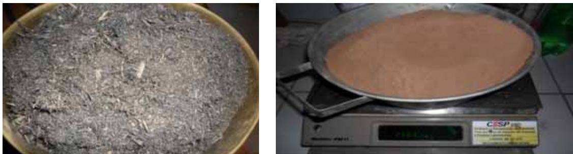
Figura 10 - Resíduo de cinza descartado e CBC pronta para passar pelo processo de moagem
