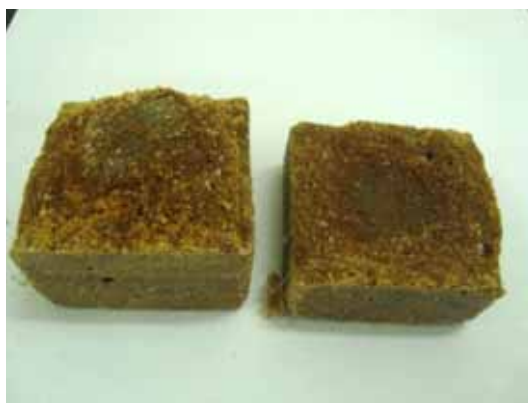
Figura 99 – Imagem dos corpos de provas atacados por HAc: Argamassa de cimento Portland
