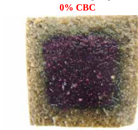
Figura 101 – Imagem dos corpos de provas atacados por HAc: Geopolímeros ativados com NaOH+ Na 2 SiO 3 .
