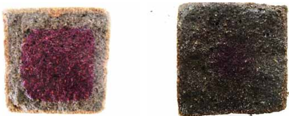
Figura 98– Imagem dos corpos de provas atacados por \text{NH}_4\text{Cl} : Geopolímeros ativados com KOH 0% CBC 25% CBC
