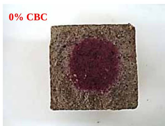
Figura 95 – Imagem do corpo de prova atacado por \text{NH}_4\text{Cl} : Argamassa de cimento Portland
