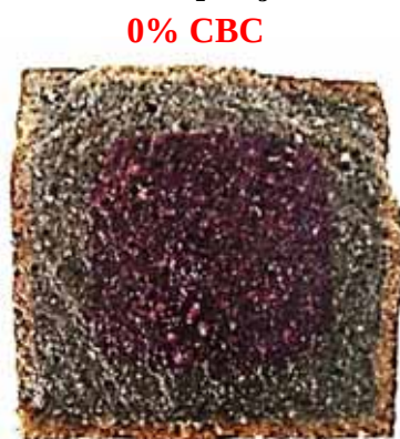
Figura 97– Imagem dos corpos de provas atacados por \text{NH}_4\text{Cl} : Geopolímeros ativados com \text{NaOH} + \text{Na}_2\text{SiO}_3 .
