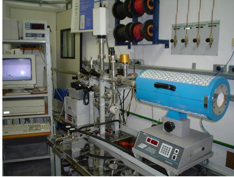
Figura 11 - Foto do sistema de tratamento térmico e dopagem
