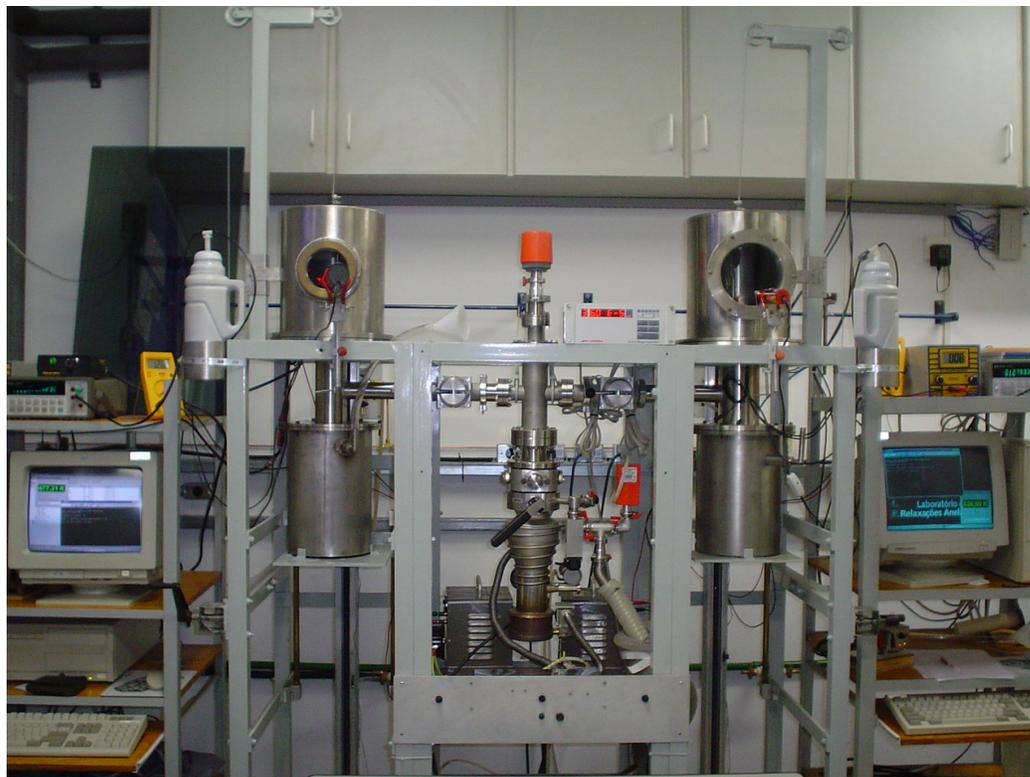
Figura 14 - Foto do pêndulo de torção.
