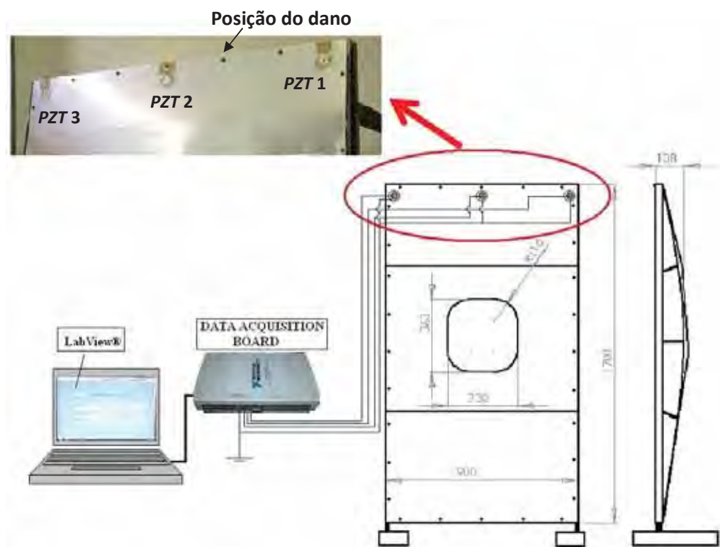
Figura 34 - Setup experimental utilizado (dimensões em mm).
