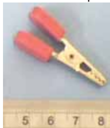
Figura 25 - Imagem do componente utilizado para simular o dano 1 (massa = 3g).
