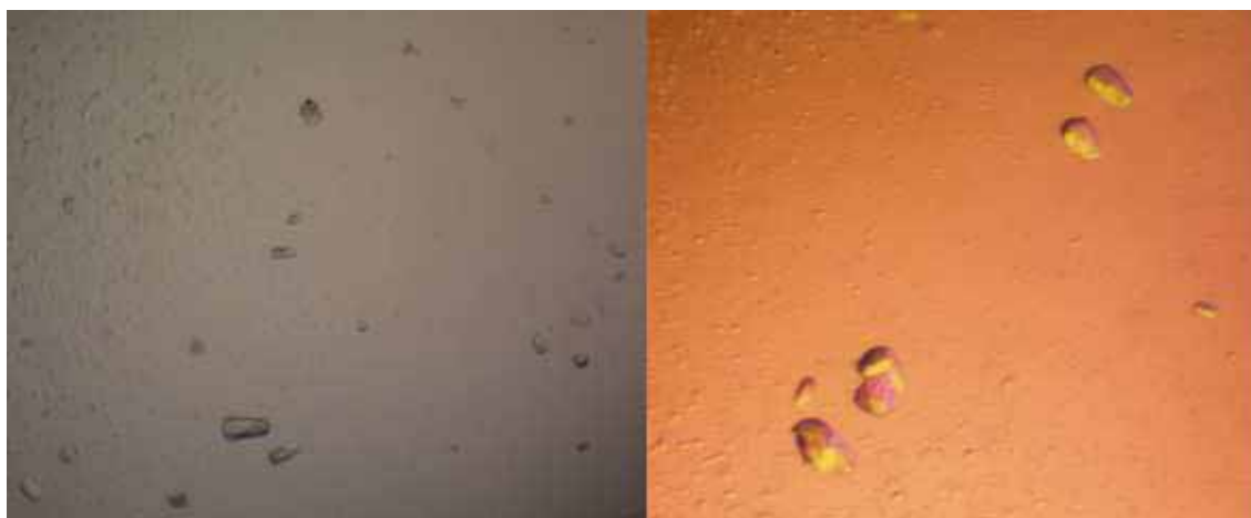
Figura 7 – Monocristais regulares de pequeno volume e cristais irregulares de BthTX-I obtidos na presença do inibidor MMV após um período de doze dias.
