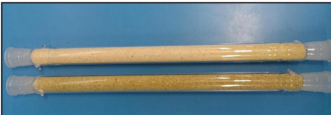
Figura 3. Representação de bagaço de cana-de-açúcar empacotado não-tratado (coluna inferior) e tratado por ozonólise (coluna superior) em colunas de pré-tratamento.
