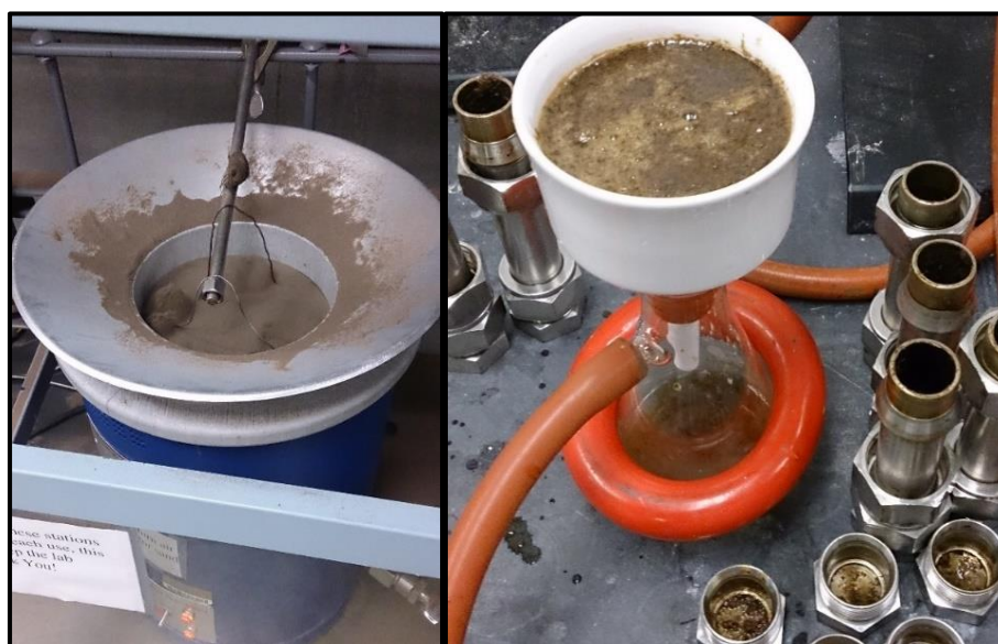
Figura 4. Banho de areia fluidizado para pré-tratamento hidrotérmico (à esquerda); procedimento de separação dos sólidos e licor após o pré-tratamento hidrotérmico (à direita).
