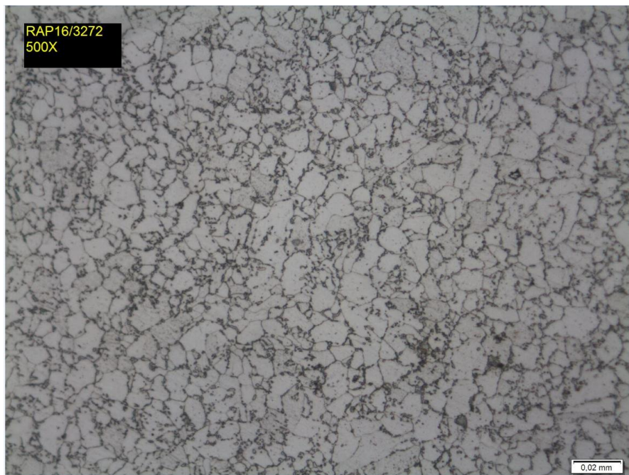
Figura 27: Micrografia do aço 5115 tratado termicamente no ciclo proposto, ESFERO2, com aumento de 500x. Ataque nital.
