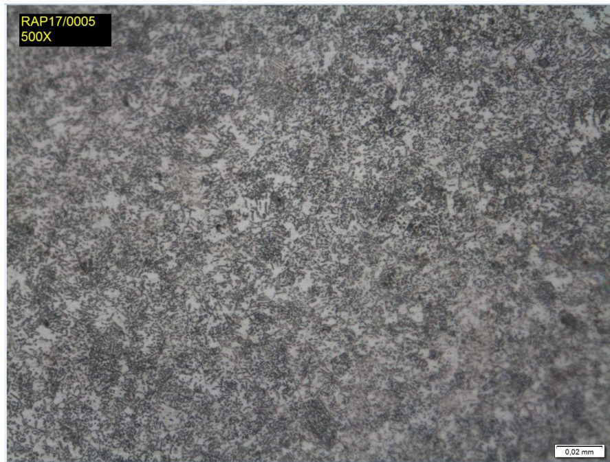
Figura 31: Micrografia do aço 5160 tratado termicamente no ciclo padrão, ESFERO3, com aumento de 500x. Ataque nital.
