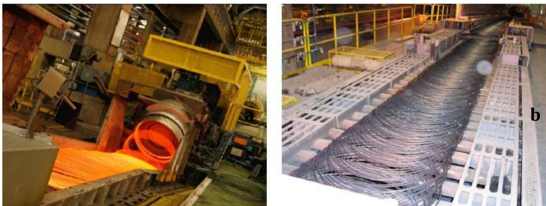
Figura 16: Formação de espiras no processo de laminação, (a) formação de espiras; (b) disposição das espiras na esteira.
