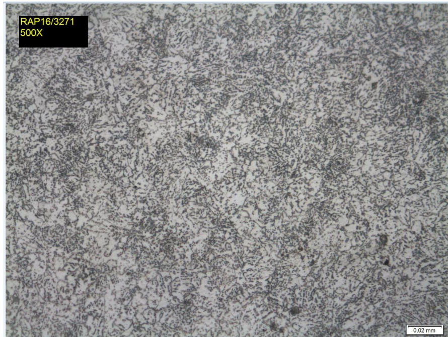
Figura 29: Micrografia do aço 5140 tratado termicamente no ciclo padrão, ESFERO2, que coincide com o novo ciclo proposto, com aumento de 500x. Ataque nital.
