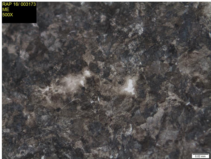
Figura 30: Micrografia do aço 5160 como recebido, com aumento de 500x. Ataque nital.
