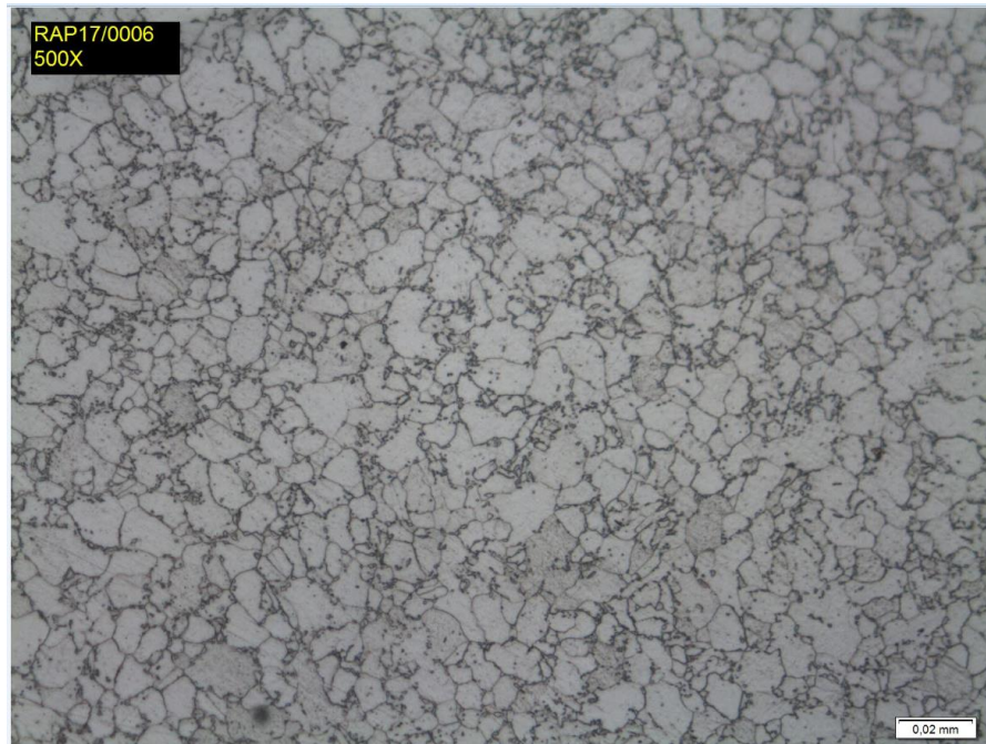
Figura 26: Micrografia do aço 5115 tratado termicamente no ciclo padrão, ESFERO1, com aumento de 500x. Ataque nital.
