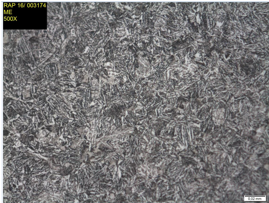
Figura 28: Micrografia do aço 5140 bruto com aumento de 500x. Ataque nital.
