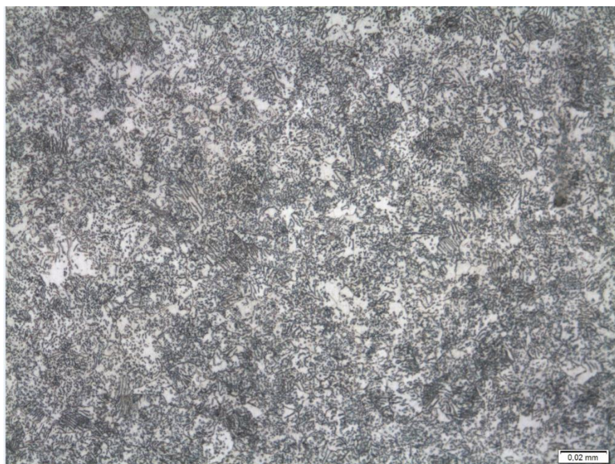
Figura 32: Micrografia do aço 5160 tratado termicamente no ciclo proposto, ESFERO2, com aumento de 500x. Ataque nital.
