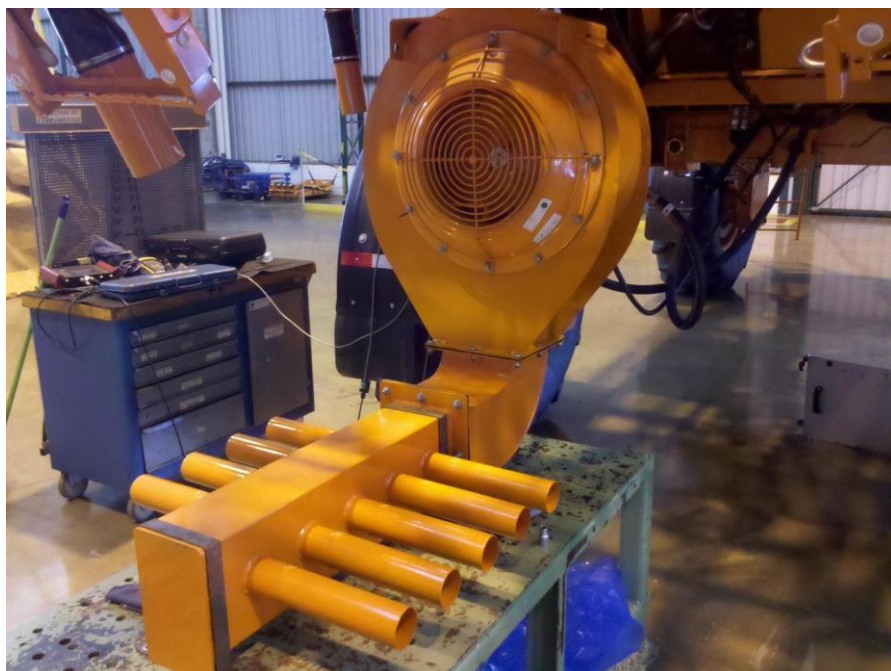
Figura 2.6 – Detalhe do sistema de distribuição de ar com rotor Jacto em bancada
