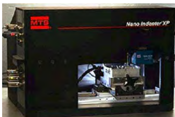
Figura 6 - Nanoindentador Nano Indenter® XP
