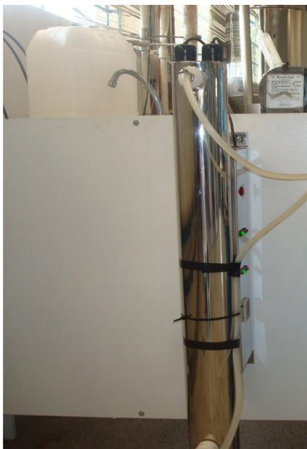
**Figura 12:** Fotoreator de radiação ultravioleta utilizado nos experimentos.
