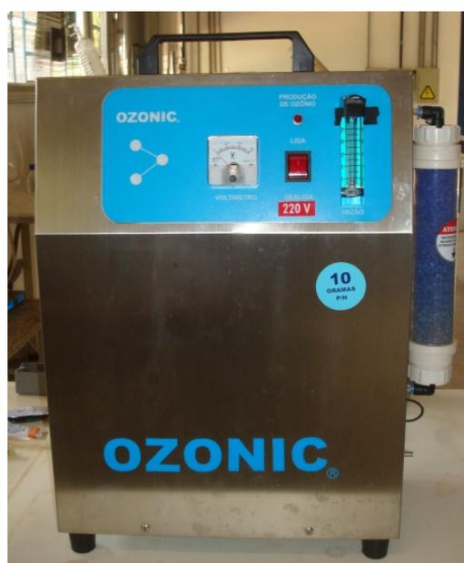
**Figura 15:** Gerador de ozônio utilizado nos experimentos envolvendo ozonização.
