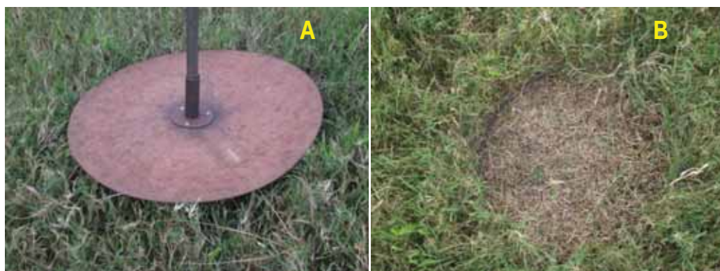
Figura 4. a – Disco para estimar altura comprimida; b – Área coletada para estimar produção de forragem
