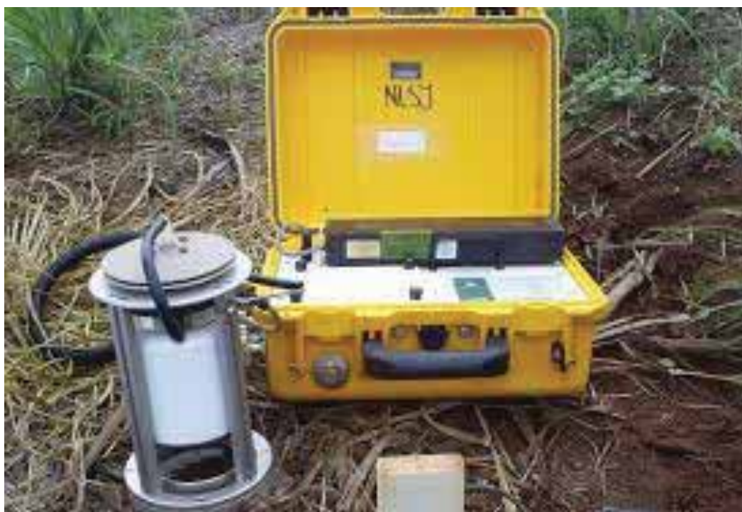
Figura 2. Coleta da emissão de dióxido de carbono pelo aparelho LI-COR
