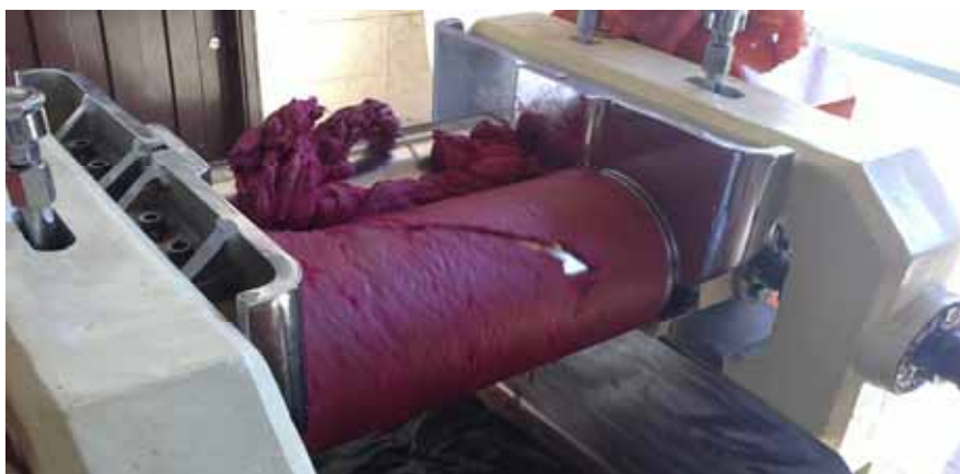
Figura 10 – Plastificação da BN e homogeneização da mistura.
