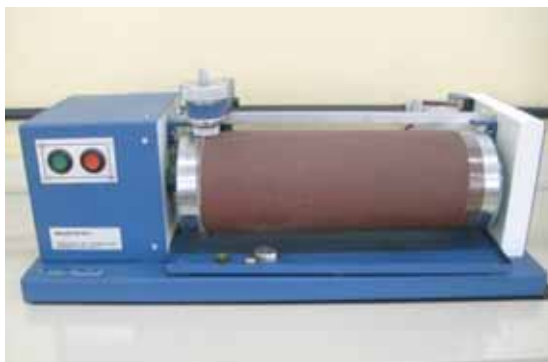
Figura 12 – Abrasímetro utilizado nos ensaios de resistência à abrasão.
