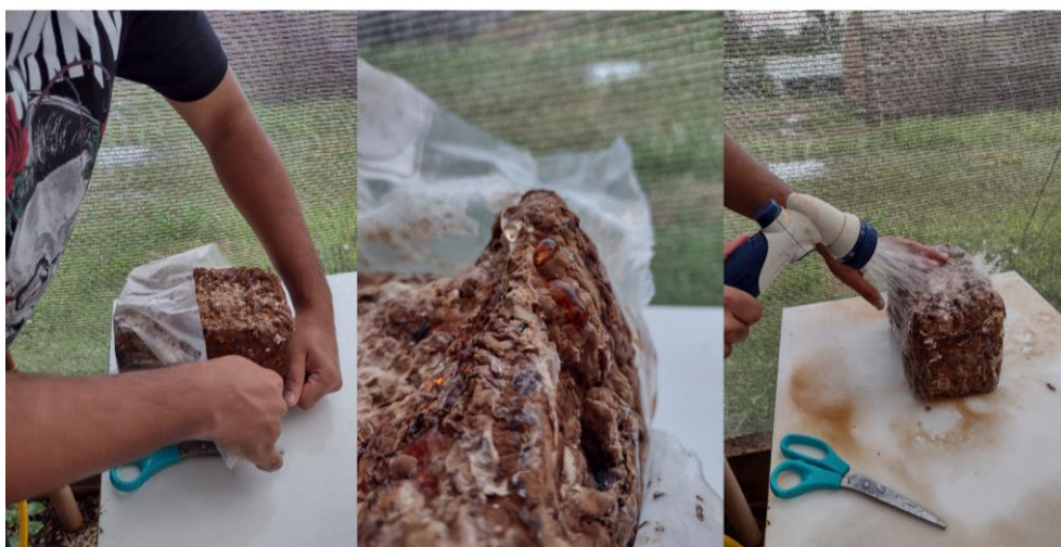
Figura 8: Retirada dos sacos de polipropileno e lavagem dos blocos.
