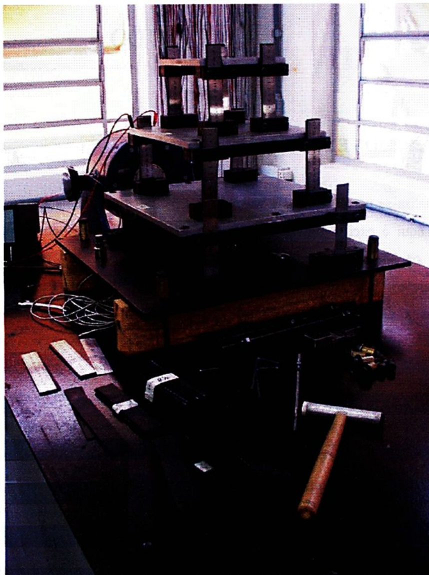
Figura 6.1: Sistema mecânico utilizado para a análise experimental. A seta mostra o sentido do movimento do conjunto das mesas.
