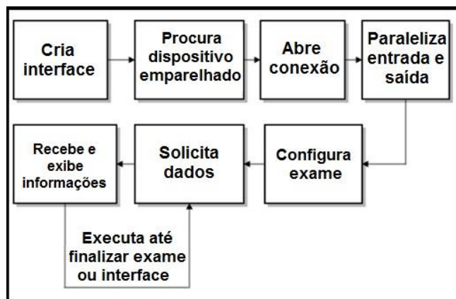
Figura 34 - Fluxograma dos passos executados para a aquisição bluetooth .
