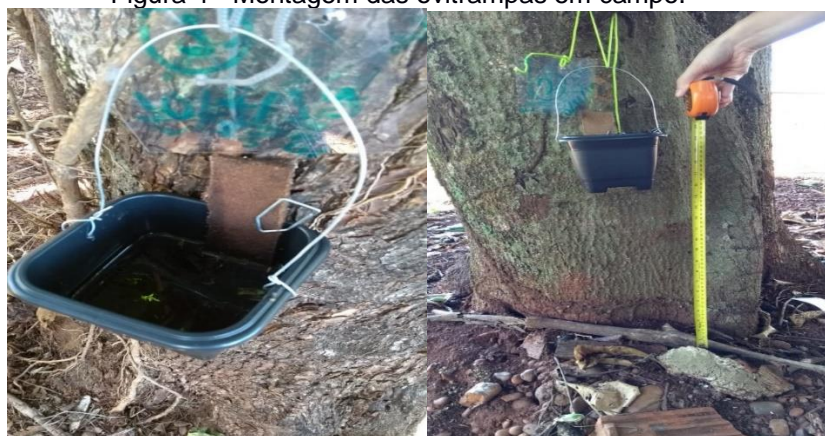
Figura 4 - Montagem das ovitrampas em campo.
