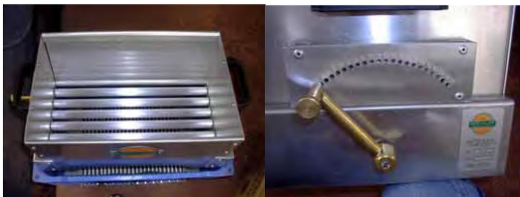
**Figura 2.** Caixa gradeadora com barras paralelas ajustáveis.
