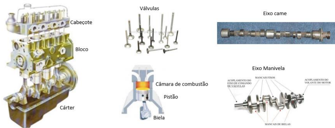
Figura 9: Principais partes do motor
