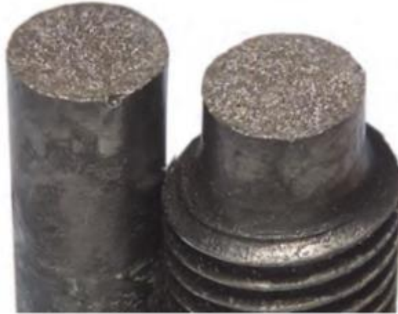
Figura 18: Superfície Fratura Frágil
