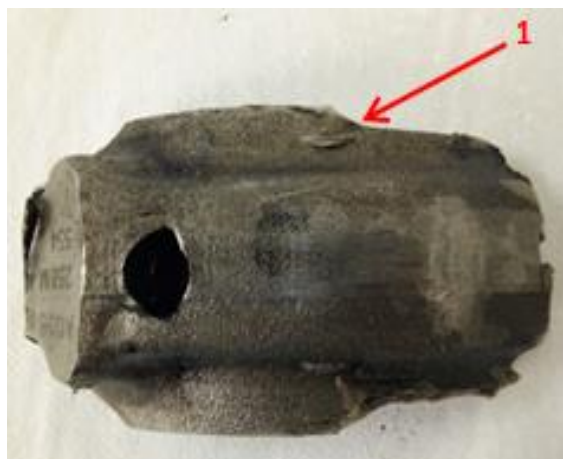
Figura 33– Biela com “Lascamentos”
