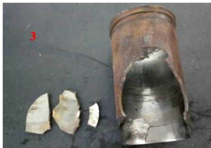
Figura 30– Camisa do cilindro onde o bloco rompeu
