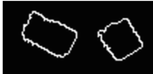
Figura 13 – Exemplo de bordas detectadas dos telhados.
