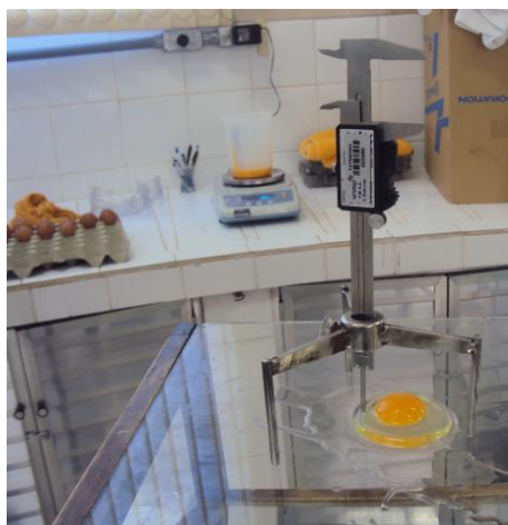
FIGURA 8: Medida da altura do albúmen utilizando paquímetro acoplado ao suporte.
