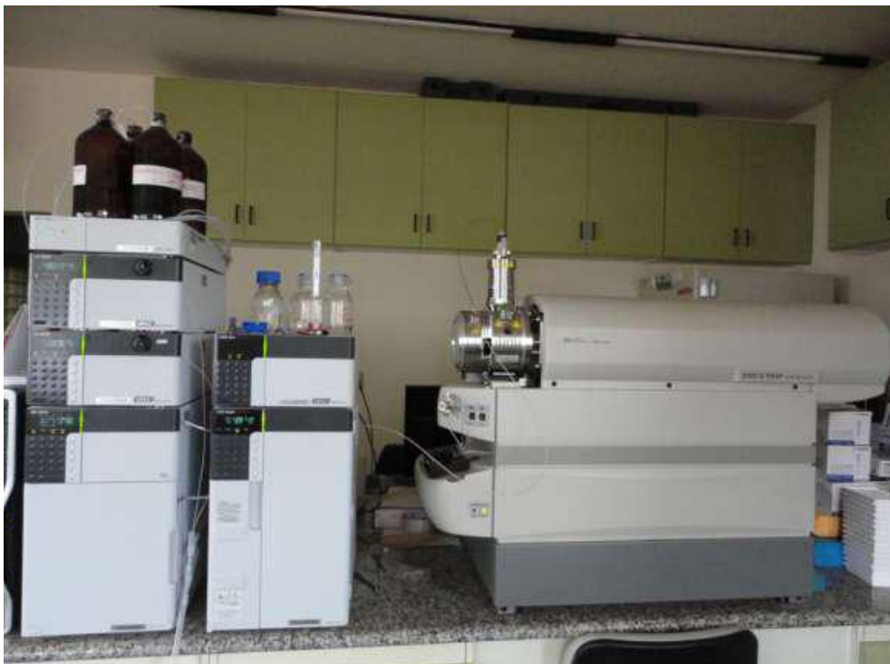
FIGURA 10: Cromatógrafo Líquido (Proeminence UFLC) acoplado ao espectrômetro de massas (3200 Q TRAP) LC-MS/MS. Botucatu/SP, 2012.
