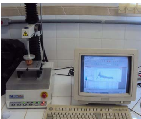
FIGURA 6: Texturômetro TA.XT plus Texture analyser utilizado para aferir a resistência da casca do ovo à quebra.
