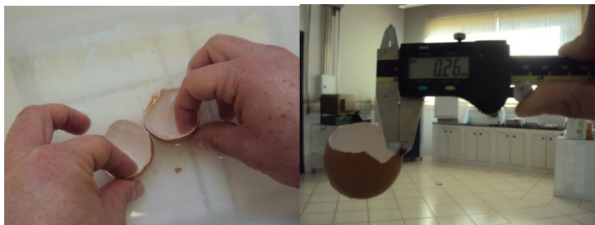
FIGURA 9: Lavagem e medida da espessura da casca com auxílio do paquímetro.
